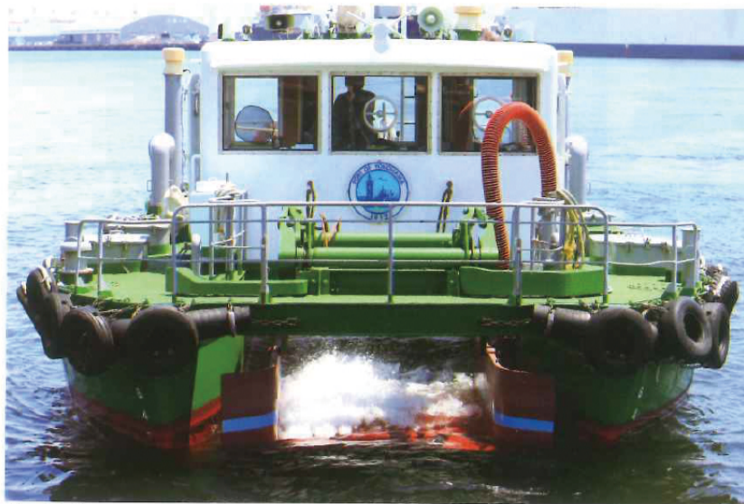
ジェット水流をおこし、海水ごとゴミを吸い込む『青海丸』。他に、船底にある熊手のような装置でゴミをかき集めるタイプの船もある。撮影：豊田直之
