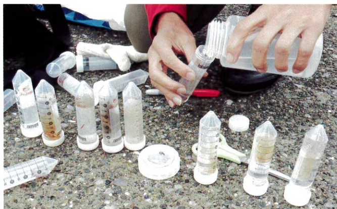
ダイバーが海底から引き上げてきたプラスチックを小さく切り取り、研究サンプルとして専用容器に海水ごと入れて持ち帰る高村教授。(撮影:K・M)
