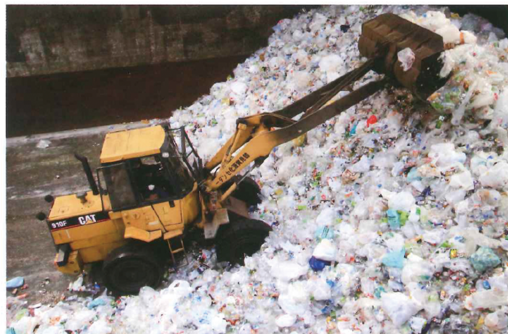
次々に運び込まれる資源物を、まずは、そのレジ袋を取り除くための機械に乗せていく。鶴見資源化センターでは、取り除いたレジ袋は隣接の工場で焼却し、自家発電として利用している。撮影:豊田直之
